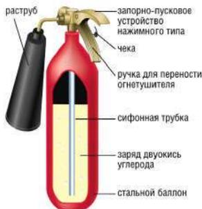
Устройство с зарядом двуокиси углерода ( $CO_2$ ) сжиженной, это позволяет снижать температуру и вытеснять кислород в месте возгорания. Углекислотные огнетушители используют для тушения следующих классов пожаров:
